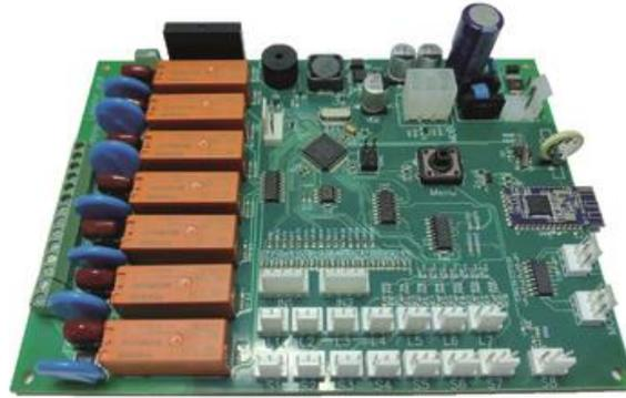
El control AquaSmart está diseñado para máquinas que venden productos a granel, como agua purificada o productos de limpieza. Este sistema permite hasta 7 selecciones de venta, cada una equipada con un sensor de flujo que mide en tiempo real la cantidad de líquido dispensado. Además, cuenta con una pantalla que permite al cliente visualizar el proceso de venta.
