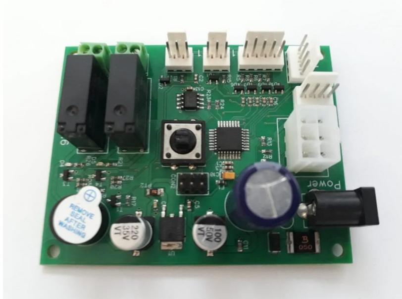
La tarjeta electrónica para expendedores automáticos miniVMC, usted podrá ser capaz de desarrollar cualquier aplicación vending OEM, ya que cuenta con entradas digitales y salidas, comunicación con sistemas de cobro MDB.
