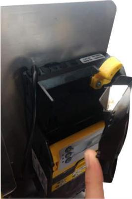
Y con aire comprimido limpiar la segunda compuerta, que redirige las monedas a los tubos para dar cambio, esto con el fin de quitar alguna partícula que pueda bloquear los mecanismos.
